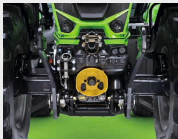
↗ Bis zu fünf proportionale Steuerventile hinten und zwei vorn. Frontkraftheber näher am Traktor und integriert.
