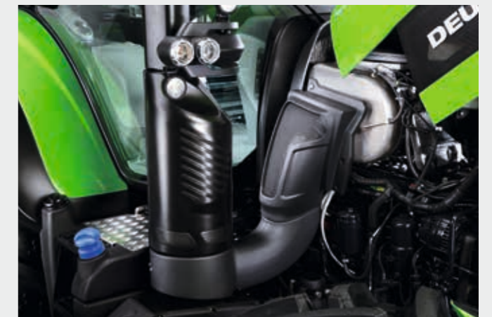
SCR-Abgasnachbehandlung und passiver Dieselpartikelfilter (DPF) sorgen für Einsparungen bei den Kraftstoff- und Betriebskosten.
