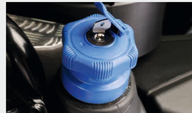
Abschließbare Tankdeckel für Kraftstoff- und AdBlue-Tank.
