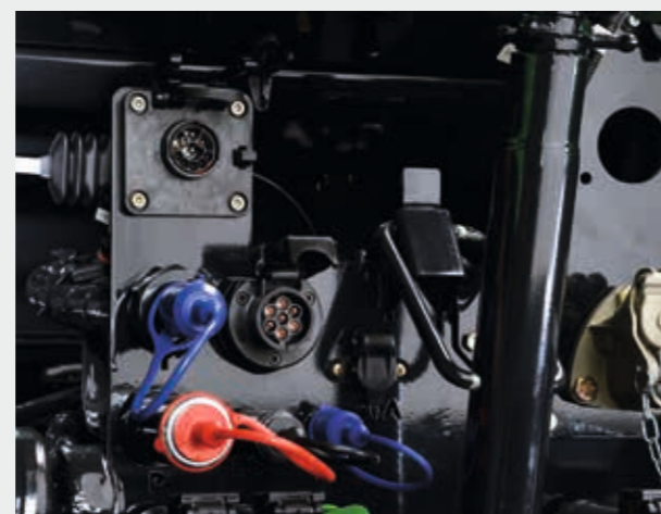
↗ Praktisch: ISOBUS-Schnittstelle heck- und frontseitig.
