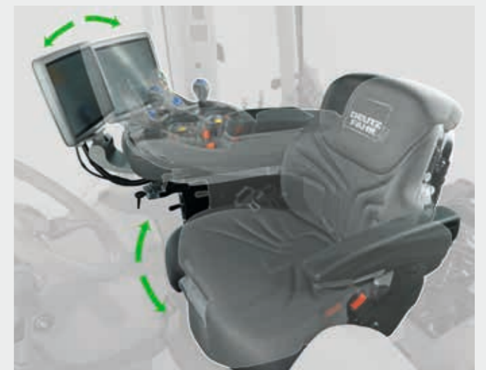
Bis zu 20° drehbarer Sitz für erhöhten Bedien- und Arbeitskomfort.
