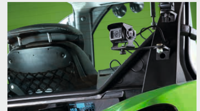
Integrierte Kamera mit automatischen Vollbildmodus (z.B. Rückwärtsfahrt) schafft Übersicht und Sicherheit.
