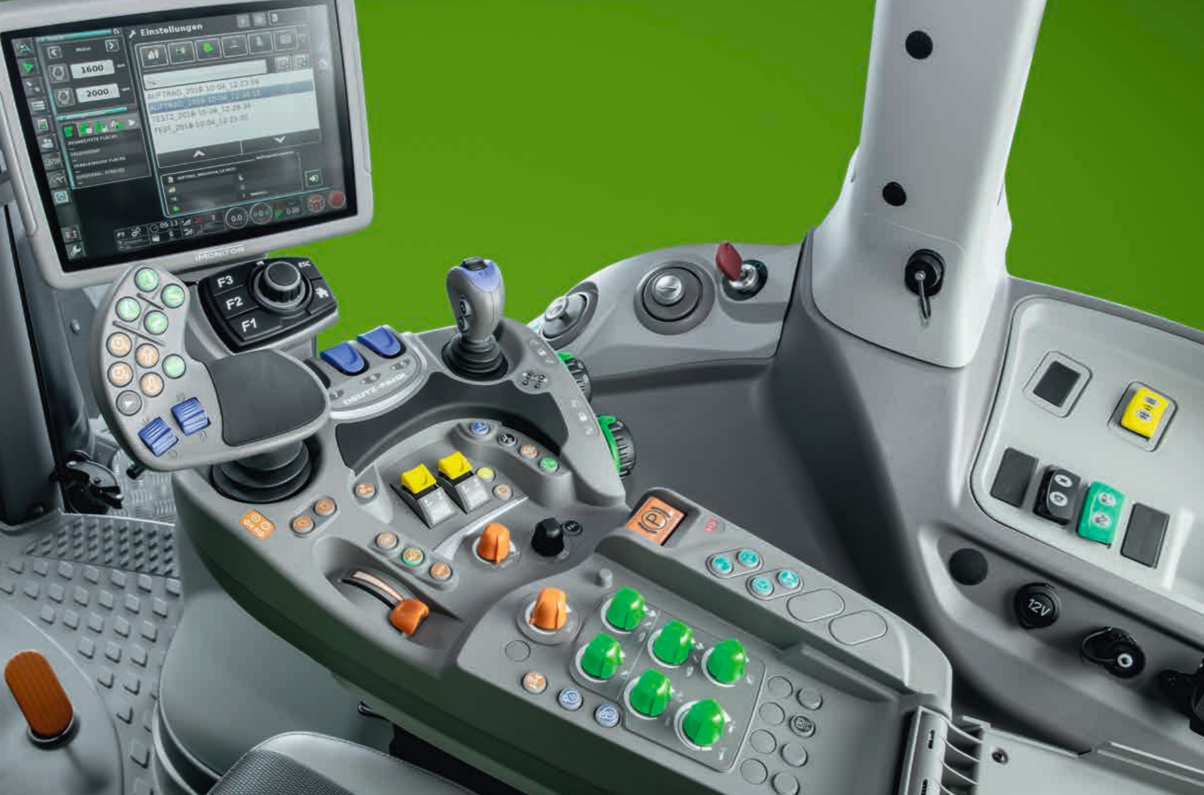
Die Zapfwellenaktivierung und -zuschaltung (front-/heckseitig) ist in die Armlehne integriert ...
