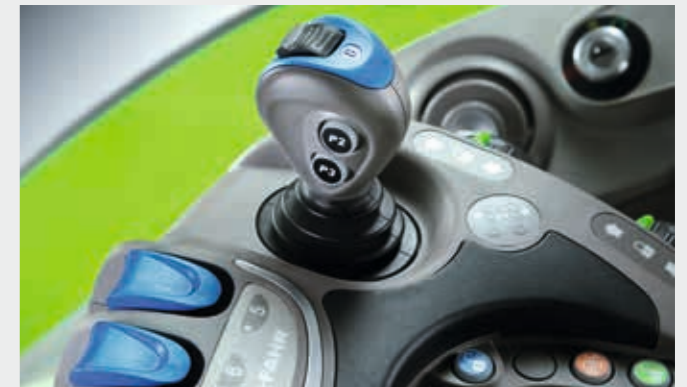
Die Hydraulikventile werden über einen Joystick mit integriertem Rändelrad angesteuert.
