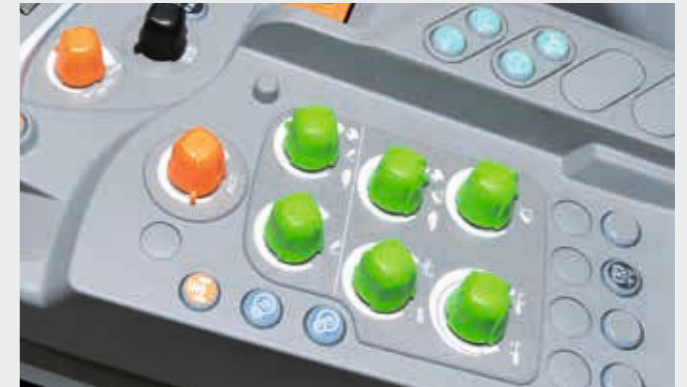
... ebenso wie die Bedienelemente des Front- und Heckkrafthebers.
