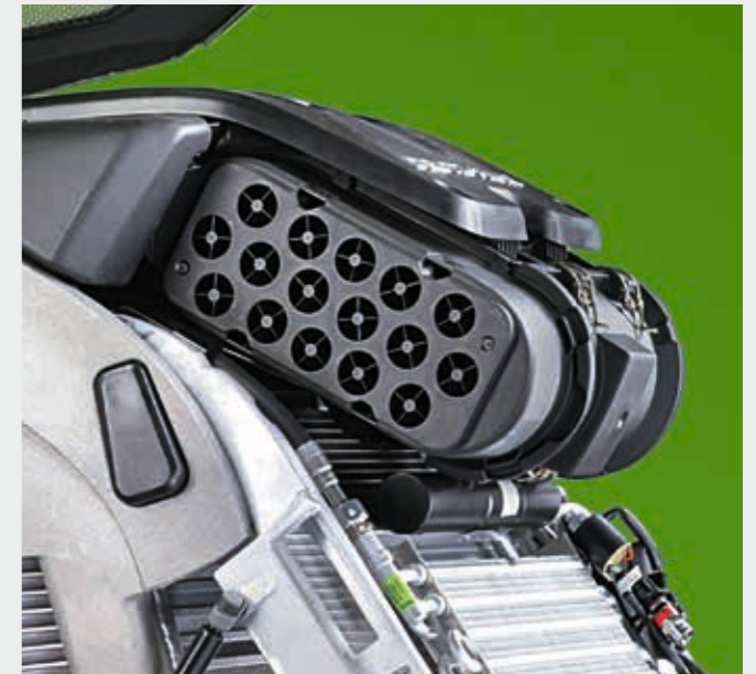
↑ Vorreinigungssystem im Motorluftfilter: Spiralförmige Zyklonrohre und Saugschläuche scheiden 95 % des Staubs ab, bevor dieser in den Hauptfilter gelangt.
