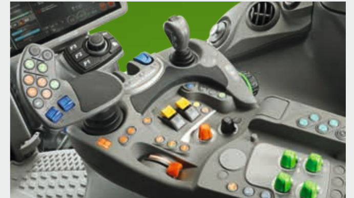
↑ RCshift: Verfügbar als Variante mit mechanischen Steuergeräten und Variante mit Multifunktionsarmlehne, elektrohydraulischen Steuerventilen und iMonitor.
