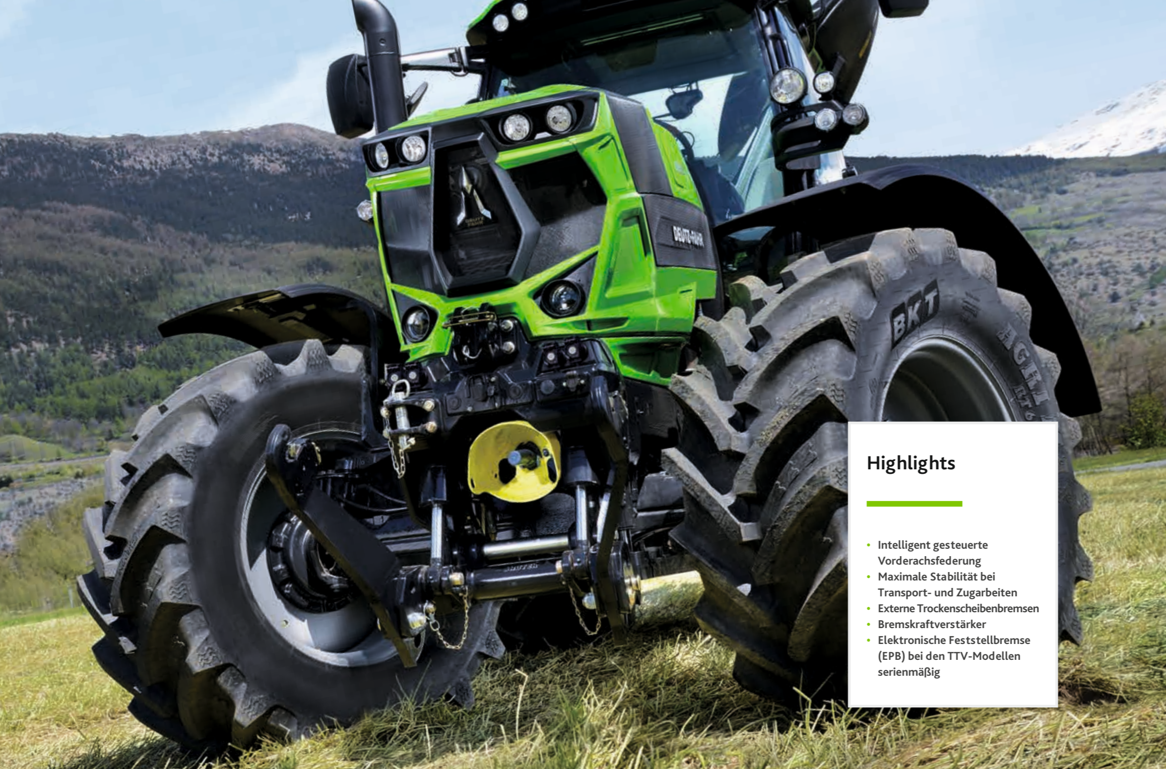
Elektronisch geregelte Federung mit Stabilitäts- und Positionskontrolle. Die Federung kann sowohl auf dem Feld als auch auf der Straße eingesetzt werden. Bei Bedarf kann sie vollständig verriegelt werden.
