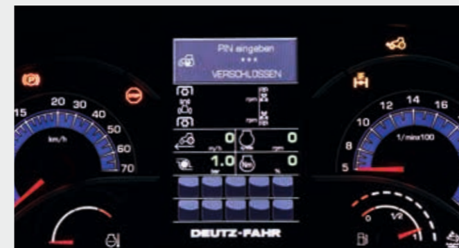
↑ Hochmoderne Instrumententafel mit InfoCentrePro: 5"-Farbdisplay und hohe Auflösung für ein benutzerdefinierbares Informationskonzept auf Topniveau. Sicherheit dank der Code-Sicherung vom Schlepper. Sperren und entsperren mit PIN.
