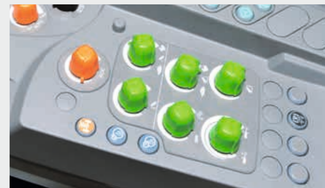
Die Feineinstellung von Frontkraftheber (nur TTV) und Heckkraftheber erfolgt über entsprechende Potenziometer in der Armlehne.
