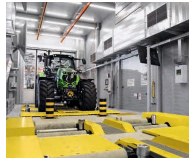
Einzigartig in der Traktorenfertigung: der Rollenprüfstand und der Achsfederungsprüfstand.
