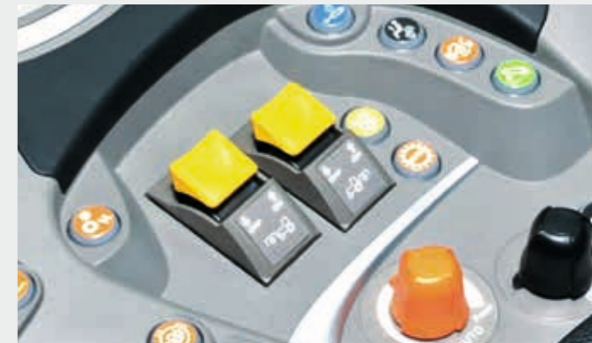
Bei allen Kabinenausführungen erfolgt die Zapfwellenschaltung standardmäßig einfach und sicher per Tastschalter.
