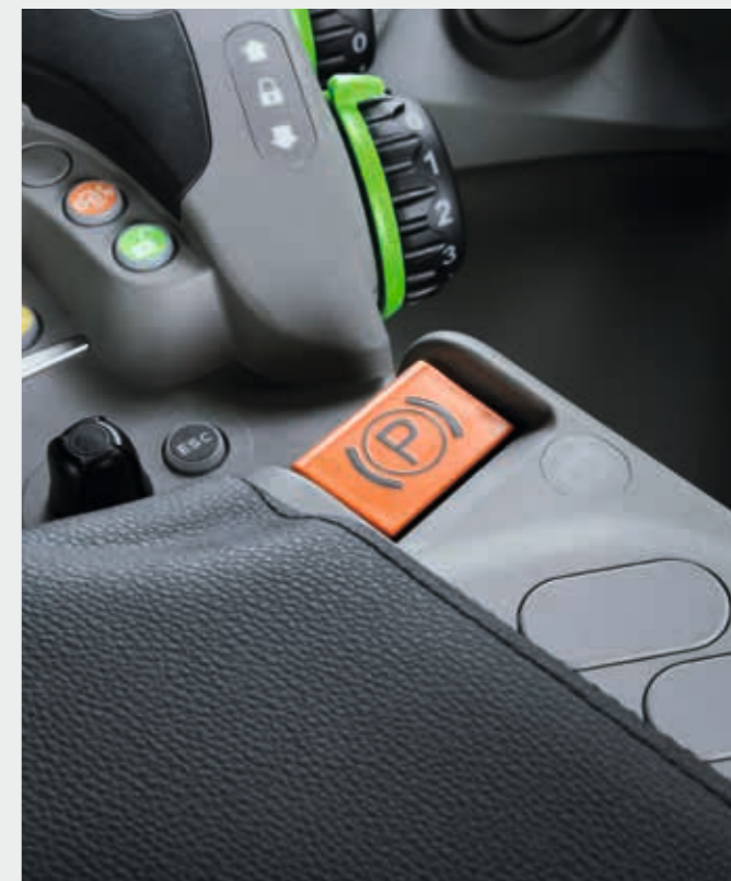
Bei den TTV-Modellen ersetzt die EPB den mechanischen Handbremshebel und wird über eine elektrische Tastensteuerung an der Armlehnenkonsole betätigt.
