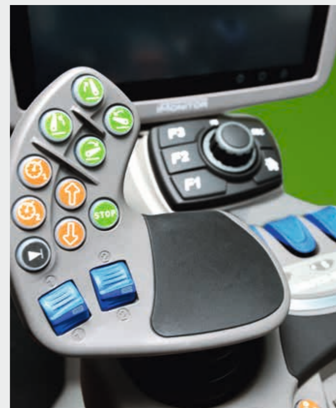
Über zwei Knöpfe am MaxCom-Multifunktionshebel kann der Fahrer vier verschiedene Geschwindigkeitseinstellungen für die Feldarbeit oder auf der Straße abrufen und eine konstante Geschwindigkeit für optimale Ergebnisse aufrechterhalten.
