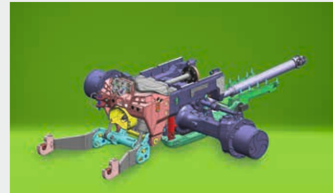
Elektronisch geregelte Federung mit Stabilitäts- und Positionskontrolle. Die Federung kann sowohl auf dem Feld als auch auf der Straße eingesetzt werden. Bei Bedarf kann sie vollständig verriegelt werden.
