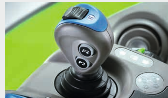
Die Hydraulikventile sind proportional steuerbar und voll auf Zeit und Menge programmierbar. Der elektronische Joystick kann programmiert werden, um den Frontlader zu bedienen, weitere Steuerventile können über das Rändelrad bedient werden.
