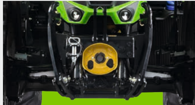
Positionsgesteuerter Frontkraftheber (TTV-Modelle) mit bis zu 5.480 kg Hubkraft.
