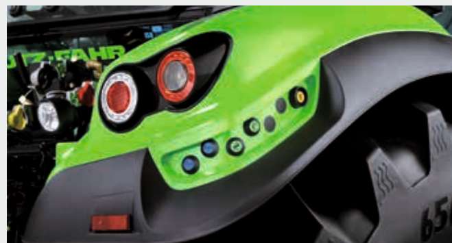
Hydraulik, Heckkraftheber und Zapfwelle lassen sich extern von jeder Seite aus leicht bedienen.
