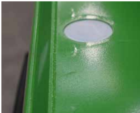
Ladeplattform vorgesehen für die Montage der Rungen
