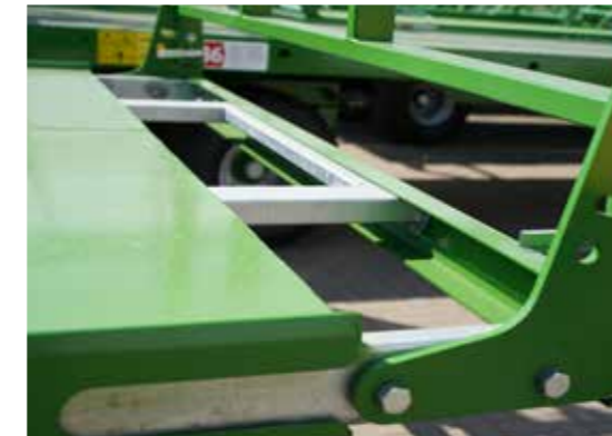
Plattformverlängerung (nicht zulässig für den öffentlichen Straßenverkehr)
